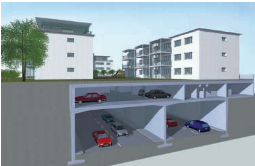
Schéma de la galerie d'autoroute. À droite, à côté du parking, décalés latéralement par rapport à l'autoroute: les caves et les locaux techniques
